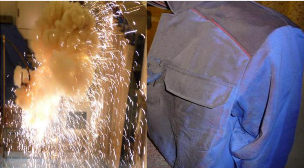
Rys. 1 przedstawia wywołanie łuku elektrycznego w komorze probierczej
